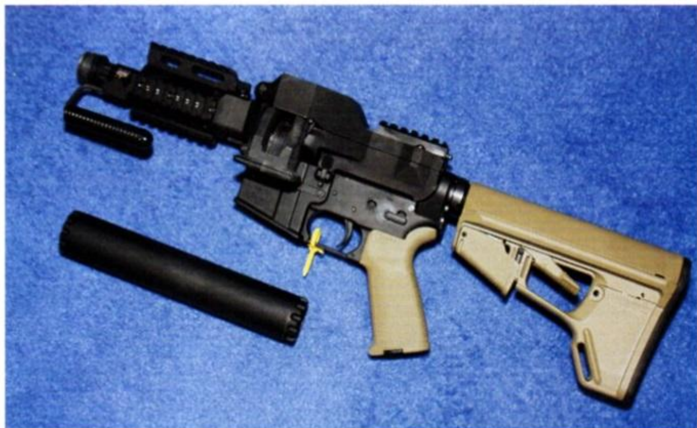
La Freedom Ordnance ha pensato di realizzare un kit calibro 9x19 con alimentazione a nastro. L'FM-9 si può installare sui lower receiver degli AR-15. Nella foto la versione con canna da 6 pollici e moderatore della Thompson Machine.
