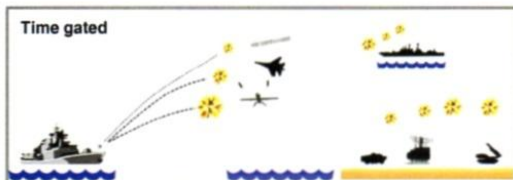
Le modalità di funzionamento della nuova spoletta FB769 sviluppata da Simmel Difesa per il munizionamento da 40L70 mm. In alto la modalità a tempo, al centro la modalità "gated proximity" con attivazione della spoletta di prossimità solo dopo aver superato la zona occupata dalle forze "amiche" e, infine, in basso la modalità a tempo. (immagine: Simmel Difesa)
