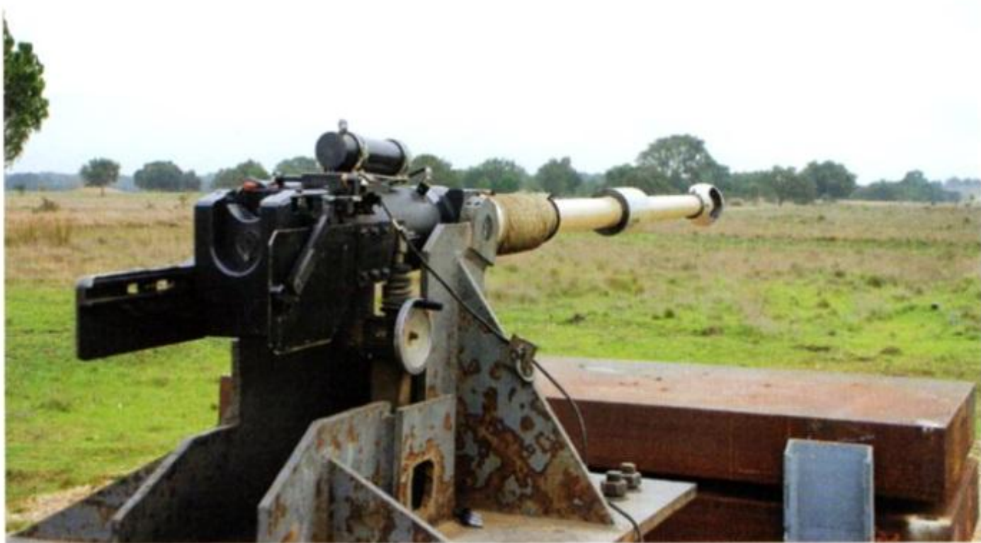
Presso il poligono portoghese di Alcochete Mekar prova tutto il suo munizionamento. nell'immagine un cannone da 90 mm tipo Mk-8 utilizzato per la sperimentazione dei colpi tipo APFSDS. (foto: Autore)
