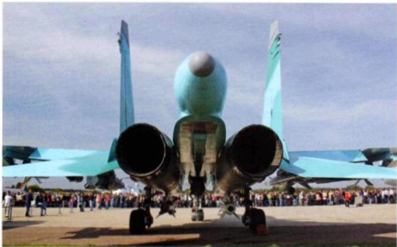
Una vista posteriore di un un Su-34 fotografato al salone moscovita Maks. In evidenza il tunnel tra le gondole motore e i numerosi carichi paganti installabili. Notare come sotto il "pungiglione" siano installati dei lanciatori di chaff & flares.
