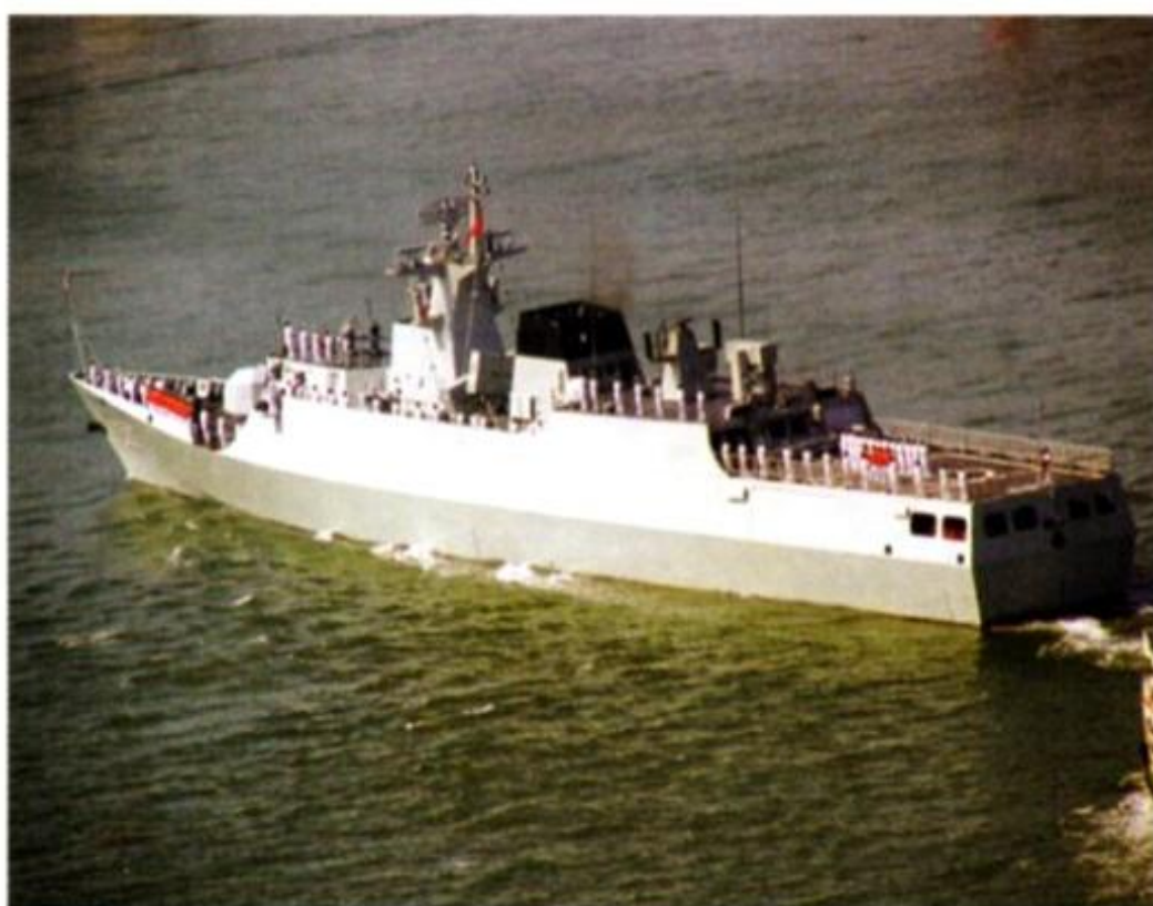
La corvetta 583 GHANZOU del tipo 056 (nome NATO JIANGDAO) della PLAN (Marina della Repubblica Popolare Cinese); anche i più recenti progetti di unità navali cinesi, come questo, presentano forme e soluzioni d'allestimento influenzate dal requisito di contenimento della segnature radar.
