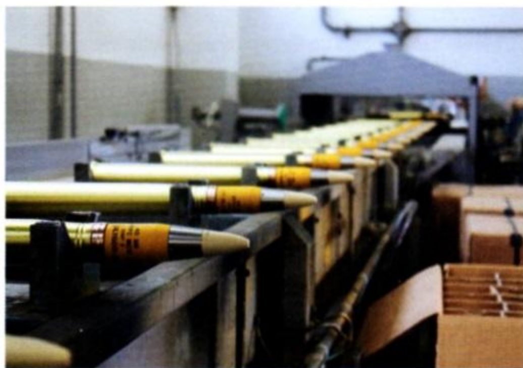
La linea di produzione delle munizioni da 40L70 mm navali presso lo stabilimento Simmel Difesa di Colleferro. Il munizionamento navale costituisce una delle eccellenze di Simmel Difesa. (foto: Simmel Difesa)
