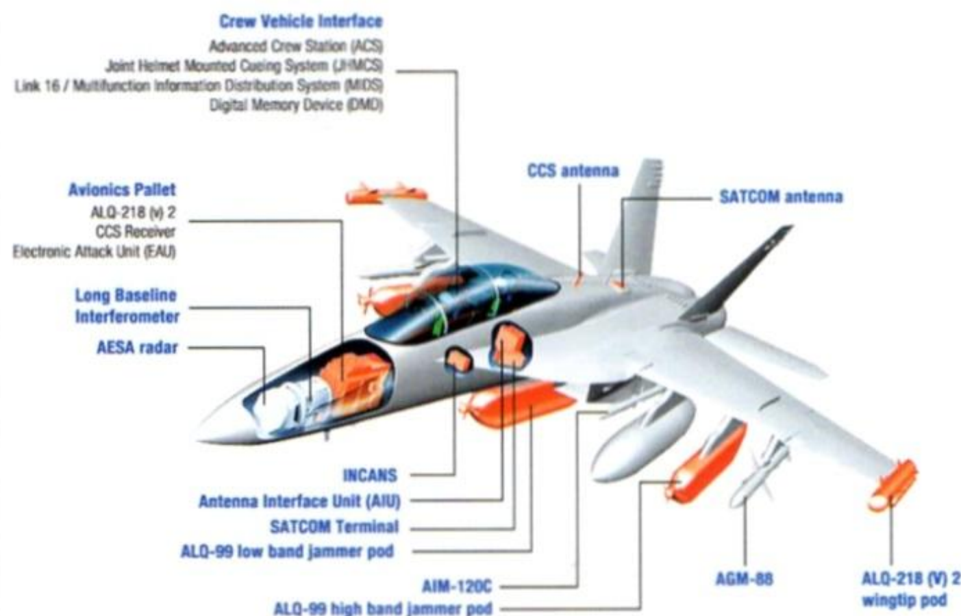
I sistemi avionico e di guerra elettronica installati sull'EF-18G GROWLER. (foto: Boeing)
