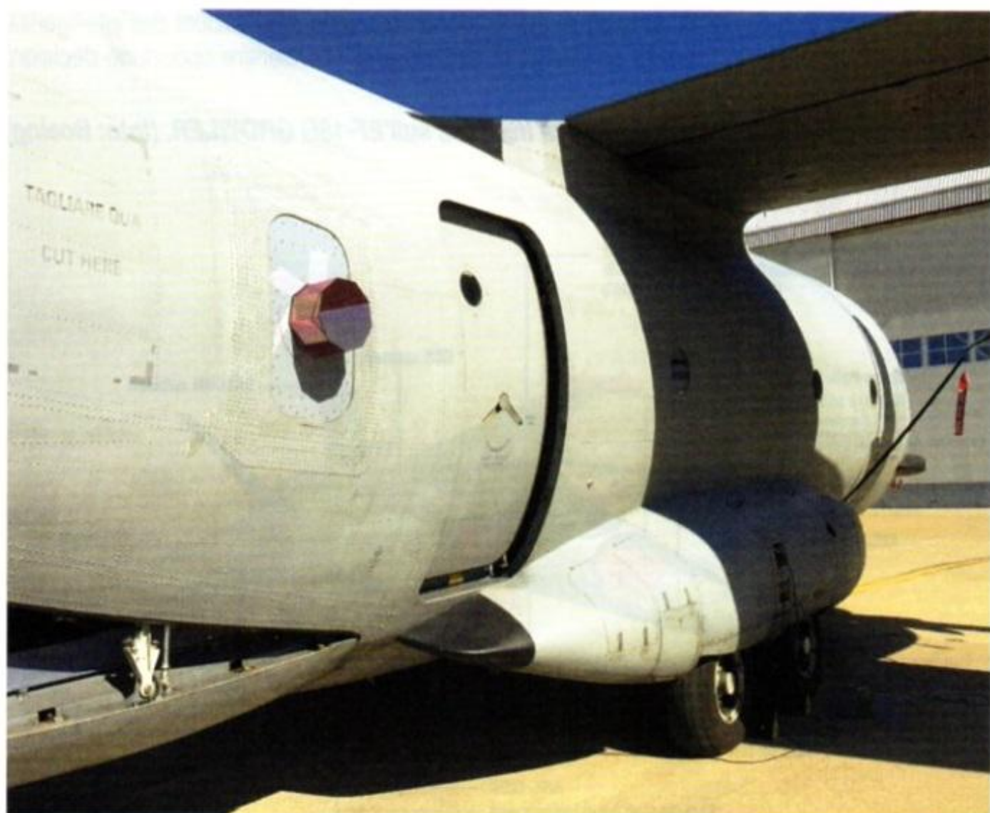
Sopra e sotto: il DIRCM ELT-572 di Elettronica installato, a scopo sperimentale, a bordo di un C-27J del Reparto Sperimentale di Volo. (foto: Elettronica)
