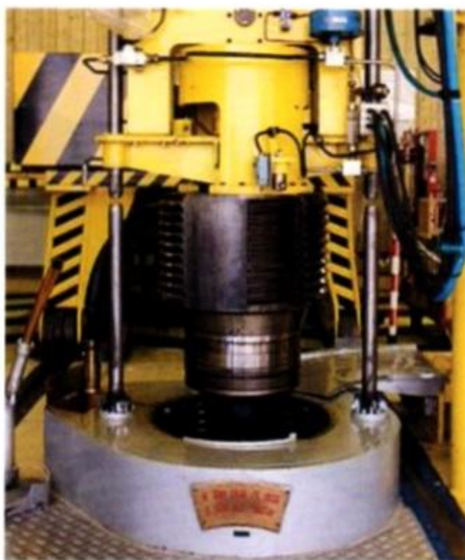
L'otturatore a vitone di una delle bocche da fuoco da 380 mm della corazzata RICHELIEU della Seconda Guerra Mondiale utilizzata per la realizzazione di cariche cave di grandi dimensioni. (foto: Nexter Munitions)
