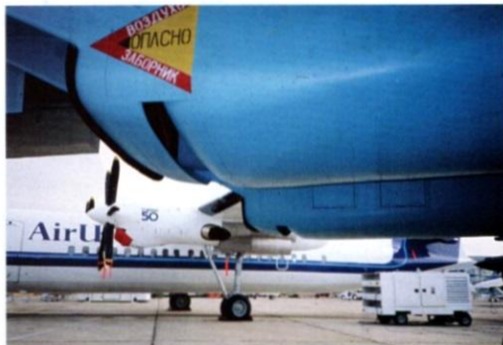
Un particolare di una delle 2 prese d'aria. Notare l'apertura fissa inferiore per scarico aria in eccesso al fine di ridurre la resistenza di spilloamento. (foto: Autore)
