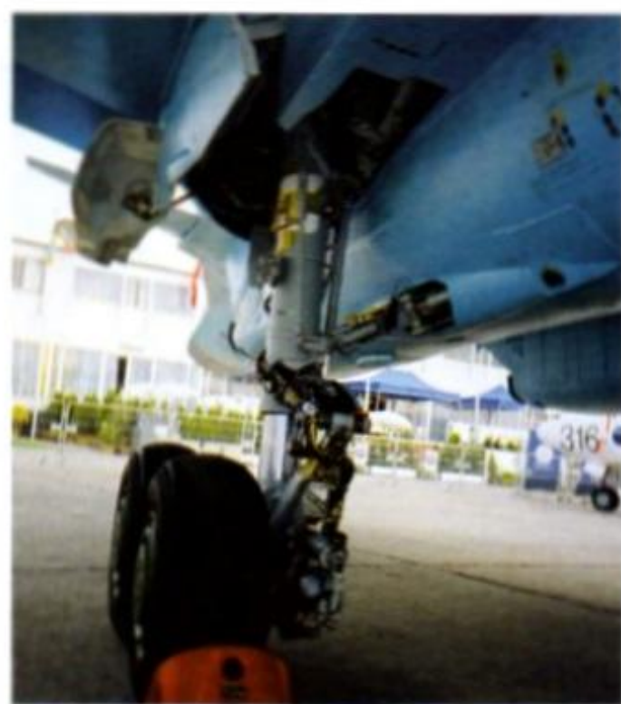
Semicarrello principale: durante la retrazione il "giogo" con le 2 ruote gira posizionandosi quasi parallelo alla gamba.
