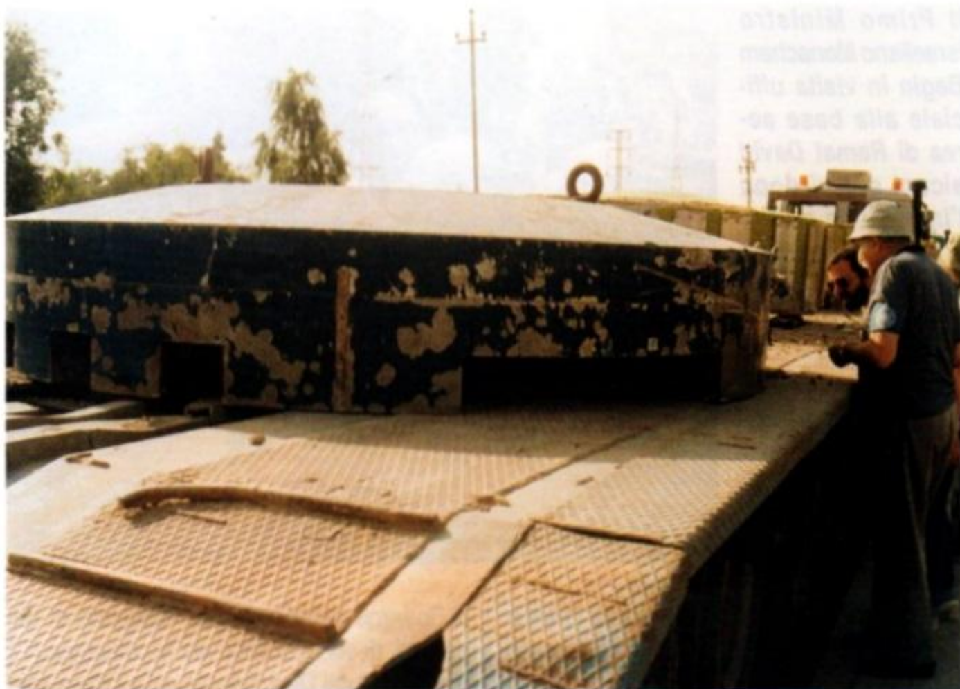
Un magnete per la separazione elettromagnetica degli isotopi dell'uranio esaminato da un ispettore della IAEA.
