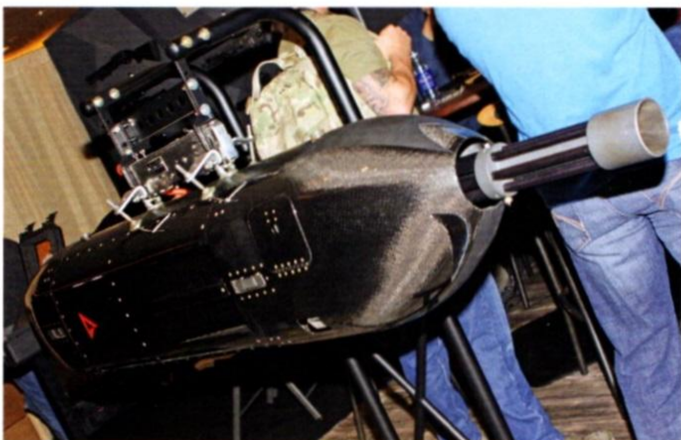
Sopra: DGP-2300 è la sigla del nuovo gunpod della Dillon Aero ospitante la mitragliatrice in acciaio e titanio M-134D in calibro 7,62x51 che, grazie al guscio in alluminio e fibra di carbonio, pesa appena 172 kg. Destinata a velivoli sia ad ala fissa che ad ala rotante, ha un rateo di fuoco di 3.000 colpi/minuto con riserva interna di 3.000 colpi. Sotto: BDT (Beretta Defense Technologies) mostrava l'ultima versione del sistema Intelligent Rail con restyling dei comandi (nella foto) e nuove potenzialità.
