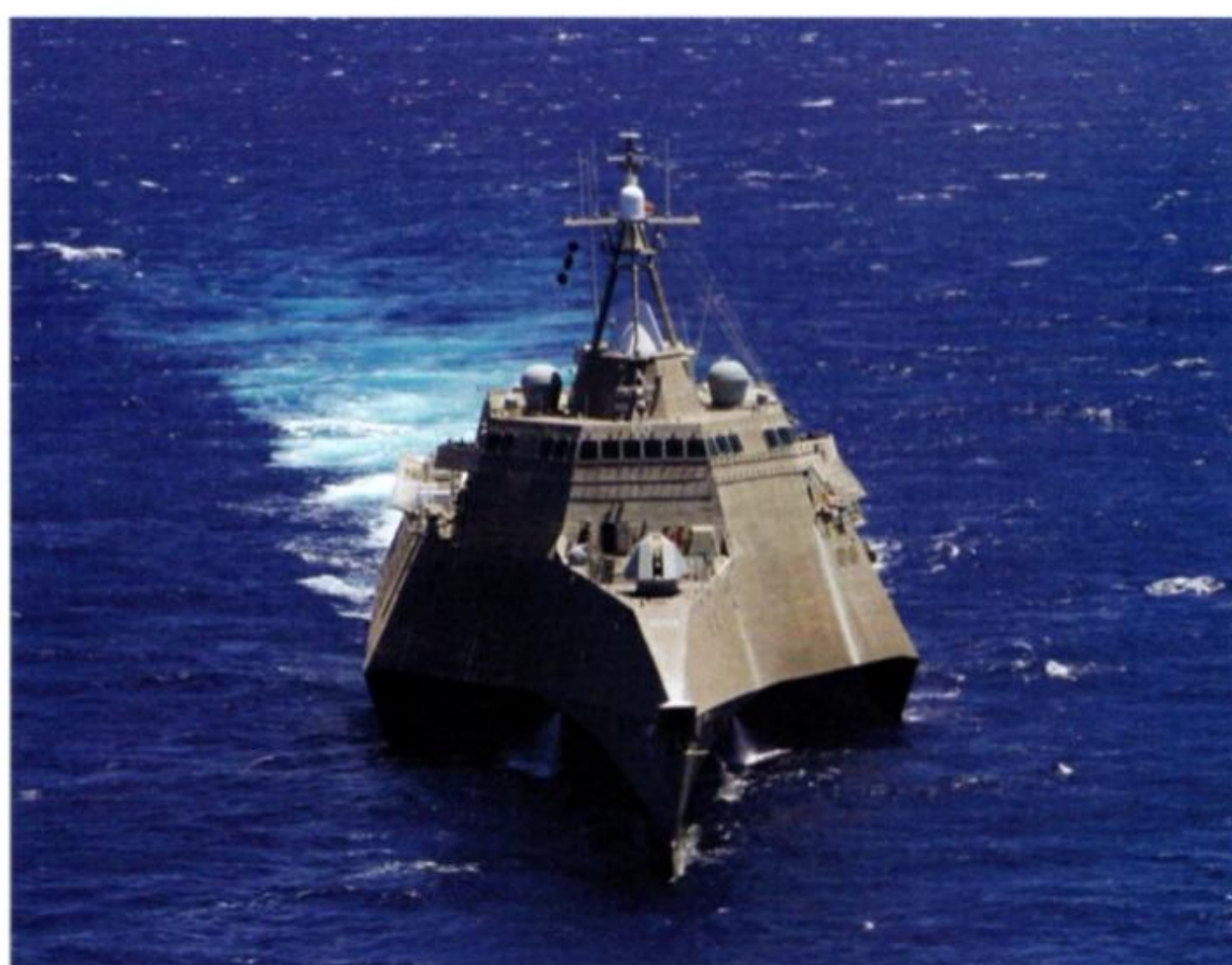
La Littoral Combat Ship LCS-02 INDIPENDENCE, unità con scafo trimarano realizzata da un consorzio guidato da General Dynamics (con Austal progettista), ripresa il 24 luglio 2014 nel corso dell'esercitazione RIMPAC 2014. Uno dei problemi per la segnatura radar di un'unità multiscafo (catamarano o trimarano) è impedire la visione della cavità situata tra gli scafi sotto il ponte. (foto: USN)
