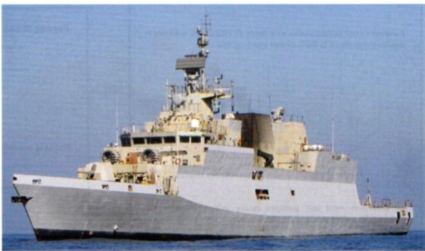
La corvetta antisom KAMORTA, consegnata il 12 luglio 2014 alla Marina Indiana; si tratta di un'unità progettata e costruita interamente in India, che presenta le tipiche forme di un progetto con controllo della segnatura radar; la presenza di alcuni sistemi d'arma e particolari d'allestimento con forme complesse privi di schermatura potrebbero però compromettere il risultato in termini di segnatura radar complessiva.
