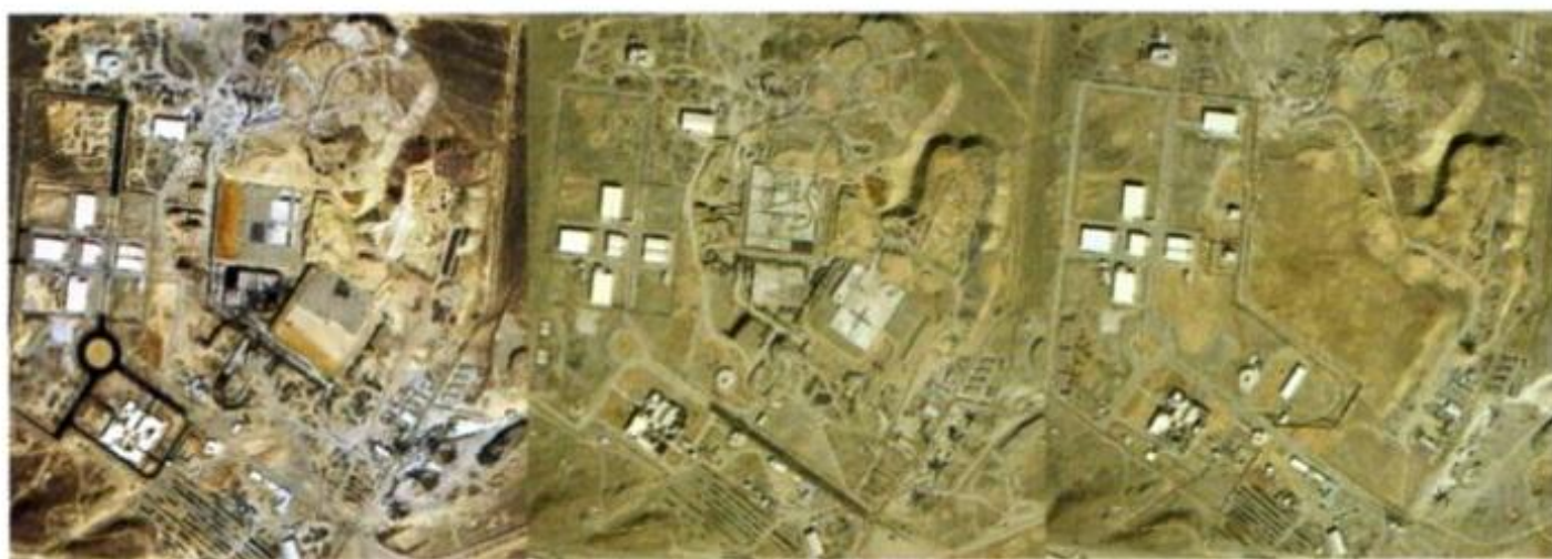
Tre fasi della costruzione del sito di Natanz in Iran, dal 2002 al 2004. Nella prima e seconda immagine da sinistra si possono notare al centro i grandi edifici contenenti le cascate di centrifughe mentre vengono coperti da strati di cemento armato e terreno. Nell'ultima le strutture ormai sono coperte e non più visibili da satellite.
