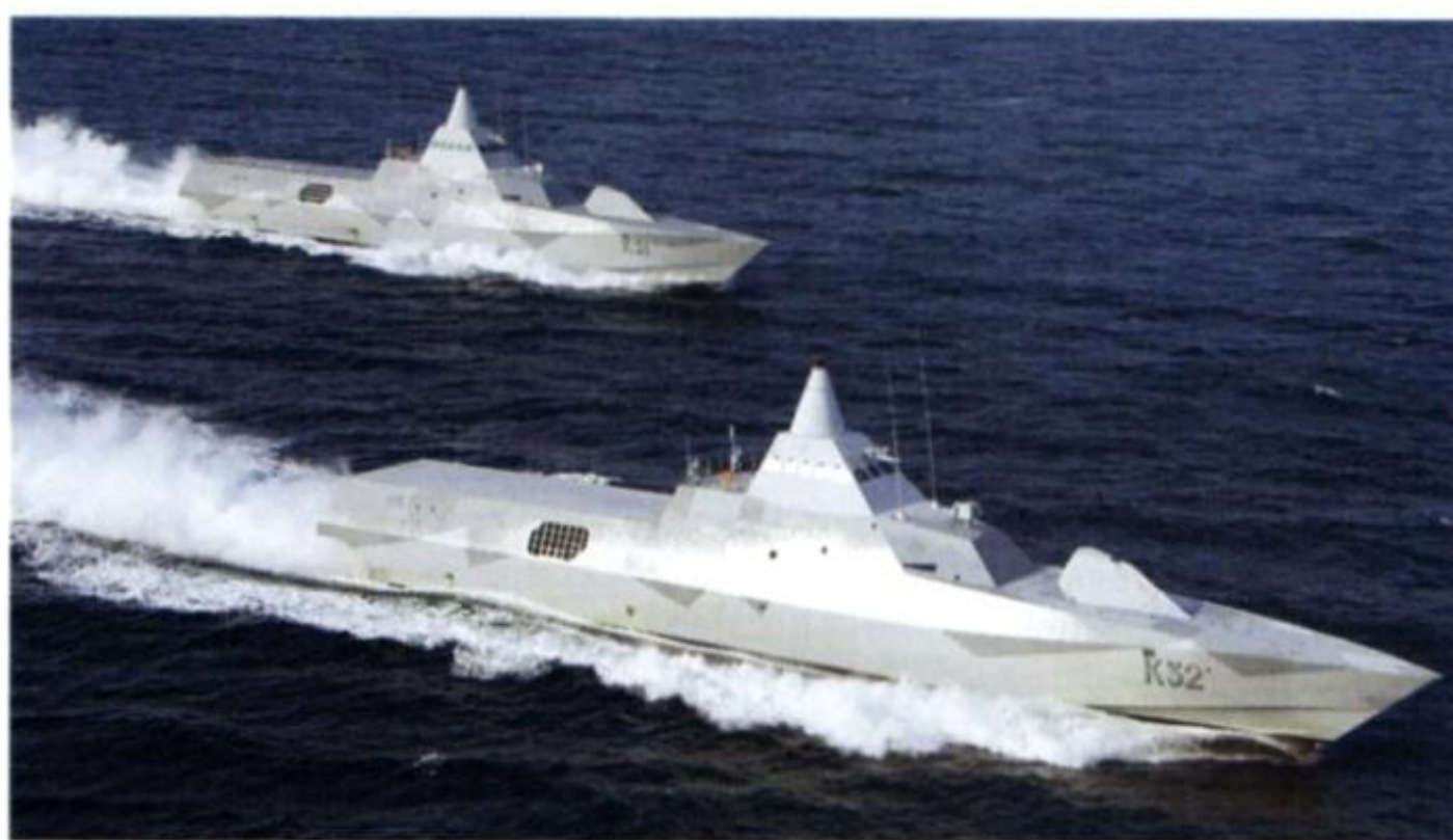
Il progetto delle corvette svedesi della classe VISBY è stato guidato dalla ricerca della minima segnatura radar. Nella foto l'unità K32 HMS HELSINGBORG (in primo piano) e la K31 HMS VISBY in moto ad alta velocità. (foto: Saab)
